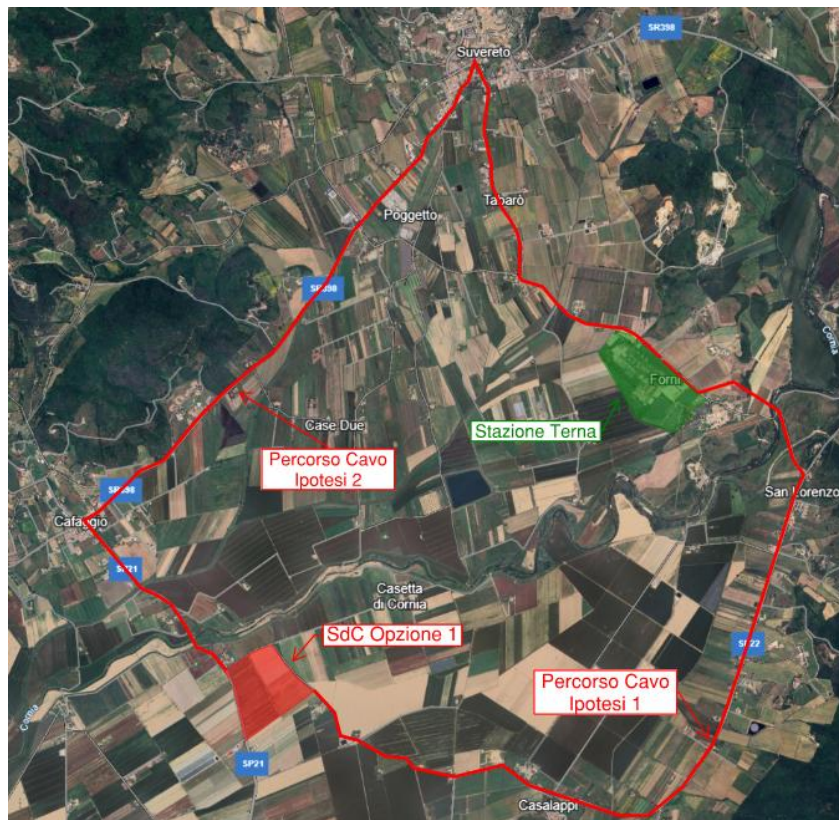
Figura 4.4.1-1 Connessione HVAC 380 kV tra la nuova SdC Opzione 1 e la S.E. Suvereto esistente (D1-A1)
